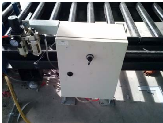
(ảnh 1: Điều chỉnh áp lực đầu vào bằng bộ điều áp)
